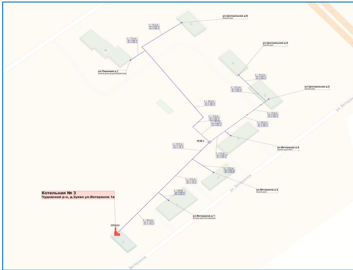
Рисунок 1.1. Схема тепловых сетей котельной № 3 д.Зуево
