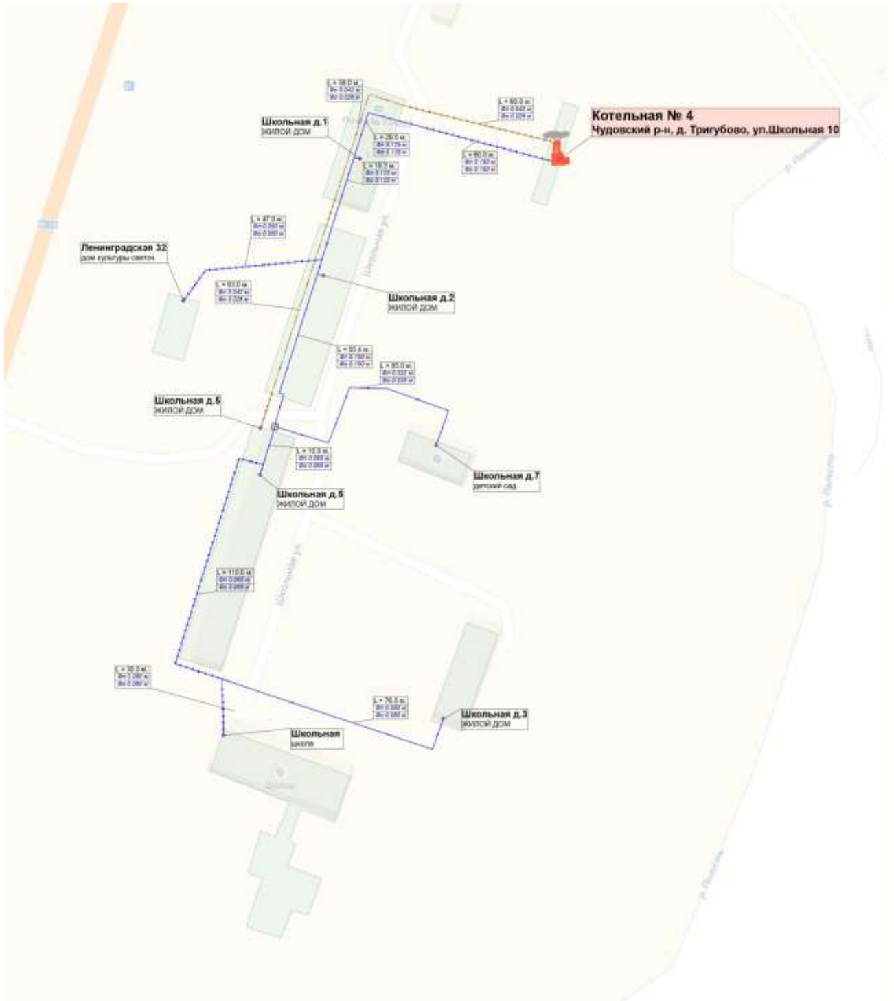
Рисунок 1.1. Схема тепловых сетей котельной № 4 д.Тругубово
