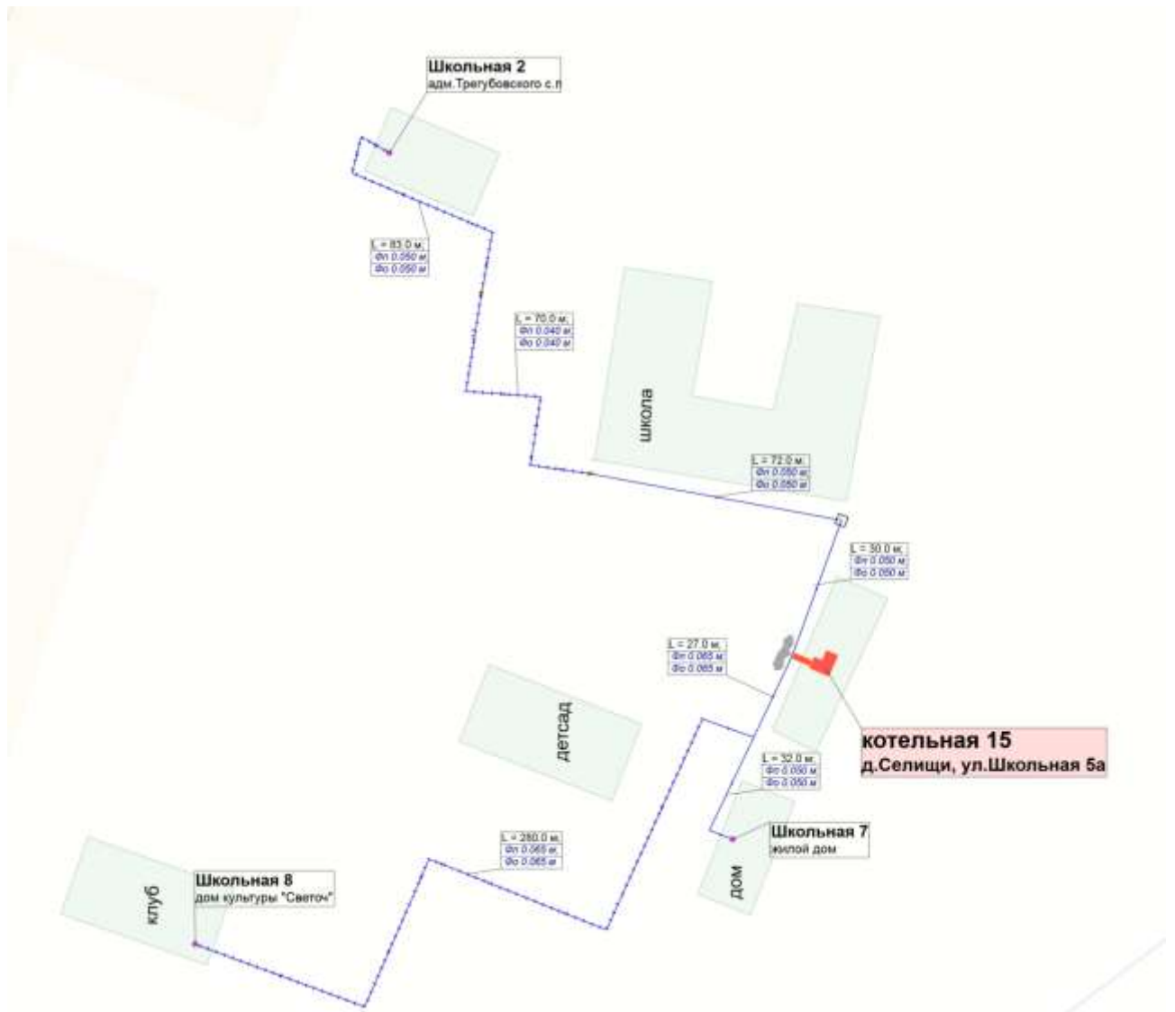
Рисунок 1.2. Схема тепловых сетей котельной № 15 д.Селищи
