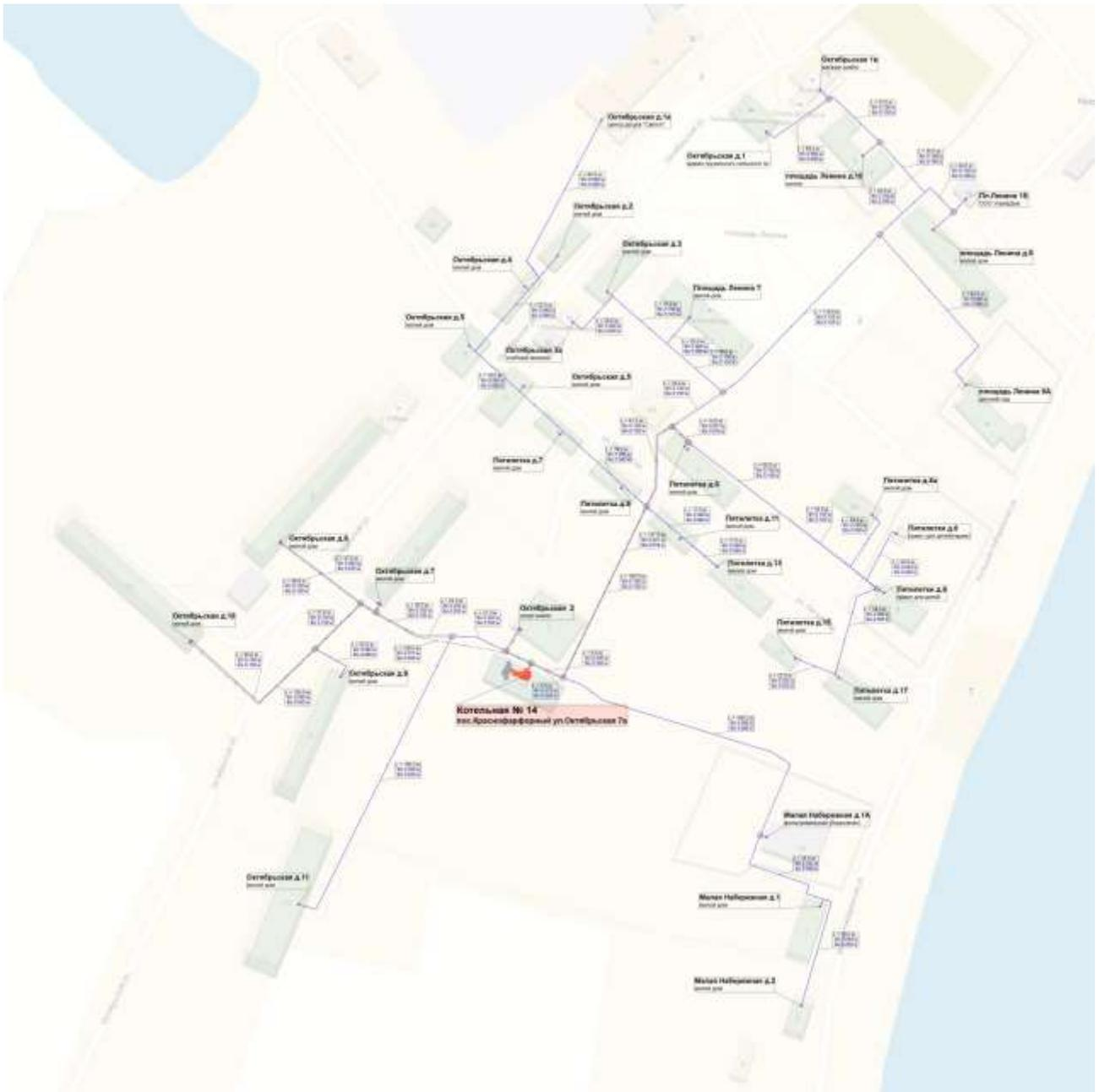
**Рисунок 1.2.** Схема тепловых сетей котельной № 14 п.Краснофарфорный
